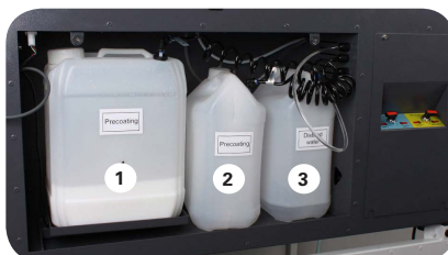
3 réservoirs embarqués et intégrés à la machine 1 : liquide de prétraitement 2 : liquide de prétraitement (possibilité d'utilisation d'un autre type de liquide) 3 : eau déminéralisée pour opération de nettoyage
